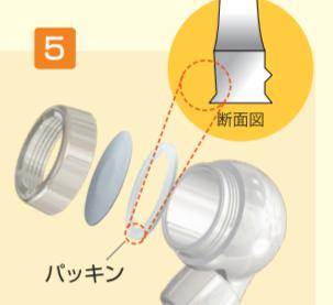
散水板とパッキンを、正しい向きで装着し、キャップをしっかりとしめ込みます。
