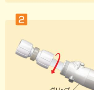
グリップをしっかりと握ってジョイント下部を矢印の方向に回し、ジョイントを取り付けます。
