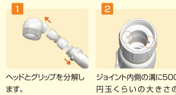
ヘッドとグリップを分解します。ジョイント内側の溝に500円玉くらいの大きさのコイン等を差し込みます。
