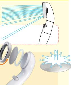
1 矢印の方向でキャップを外し散水板をよく洗ってください。
