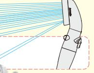
1 矢印の方向でキャップを外し散水板をよく洗ってください。
