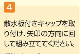
散水板付きキャップを取付、矢印の方向に回して組み立ててください。
