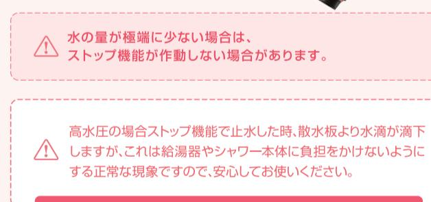
高水圧の場合ストップ機能で止水した時、散水板より水滴が滴下しますが、これは給湯器やシャワー本体に負担をかけないようにする正常な現象ですので、安心してお使いください。
